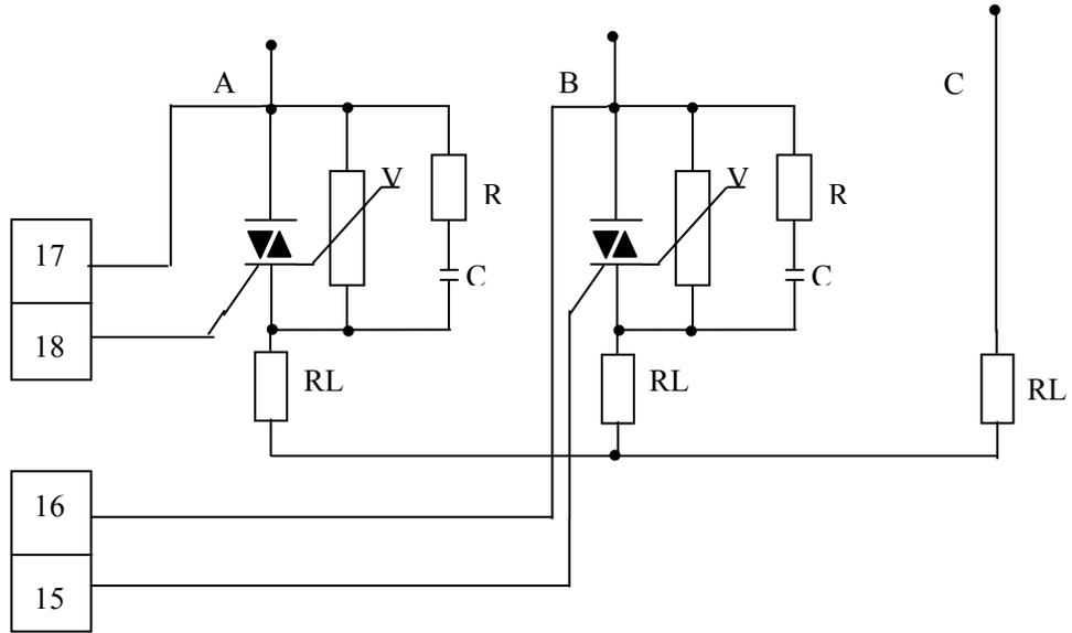
接双向可控硅，负载为 Y 形不接零线图
